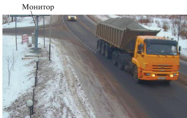
**Рис. 5.** Автомобиль с грузом с допустимой активностью проезжает мимо монитора (монитор в левом верхнем углу виден с торца).
