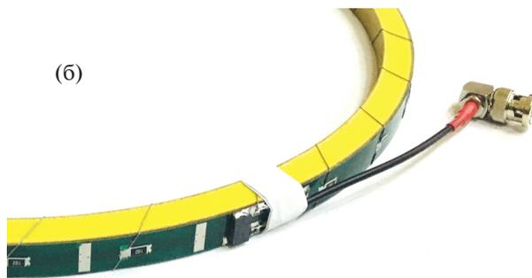
Рис. 4. Схема трансформатора тока (а) и внешний вид части сердечника с обмоткой и резисторами (б).
