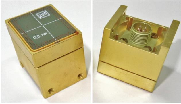
Рис. 3. Фотографии измерительной с.в.ч.-головки: слева – со стороны печатной платы, справа – с противоположной стороны.
