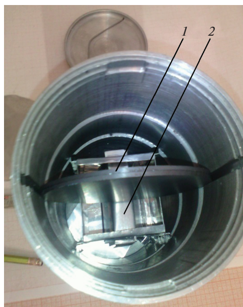
Рис. 6. Внешний вид детектирующих дисков (1) и торца пакета из 20 селективирующих пластин (2) в контейнере во втором и третьем экспериментах.
