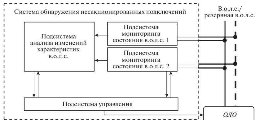
Рис. 2. Структурная схема системы обнаружения несанкционированного подключения. ОЛО – оптическое линейное окончание.
