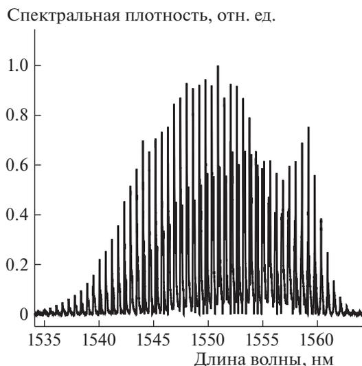
**Рис. 4.** Спектр мощности зондирующего излучения прибора FX300 (зарегистрирован при помощи оптического анализатора спектра Yokogawa (Япония) AQ6370D; спектральное разрешение – 20 пм).
