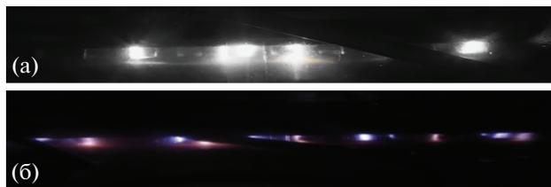
**Рис. 5.** Фотографии многоканального разряда в л.г.р. без дополнительных шунтирующих конденсаторов по 2.3 пФ (а) и с ними (б). Без использования конденсаторов количество наблюдаемых каналов 4, с использованием — 10.
