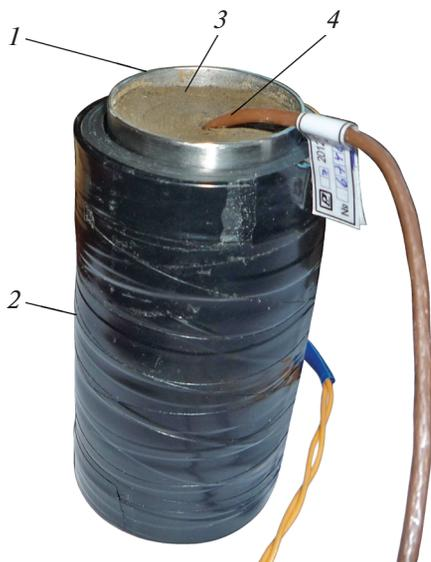
**Рис. 2.** Бюкс с грунтом. 1 – бюкс; 2 – датчик теплового потока; 3 – исследуемый грунт; 4 – термометр сопротивления.
