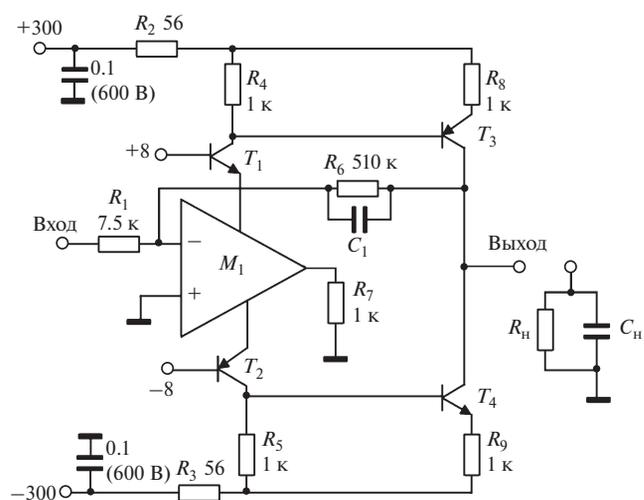
Рис. 1. Принципиальная схема в.в.-усилителя.  $M_1$  – TL082 (AD2177);  $T_1, T_4$  – TSC966,  $T_2, T_3$  – TSA1765;  $R_2, R_3$  – датчики тока,  $R_H, C_H$  – нагрузка.
