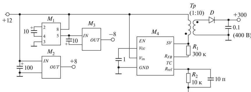
Рис. 4. Принципиальная схема источника питания.  $M_1$  – ICL7662,  $M_2$  – 78L08,  $M_3$  – 79L08,  $M_4$  – LT8304-1;  $D$  – BA158G;  $Tr$  – SUMIDA 13324-T087.
