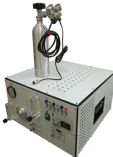
Рис. 1. Внешний вид газоразрядного лазера ЛВС-1.
