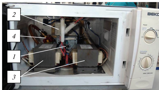
Рис. 3. Блок магнетрона в корпусе печи Beiko. 1 — магнетрон; 2 — волноводный с.в.ч.-вывод; 3 — высоковольтные трансформаторы; 4 — реле блокировки по воде.
