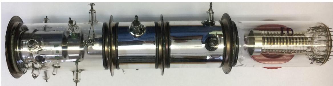
Рис. 1. Внешний вид электронно-вакуумной части диссектора.
