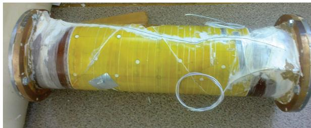
Рис. 2. Соленоид после пропитки эпоксидным компаундом.
