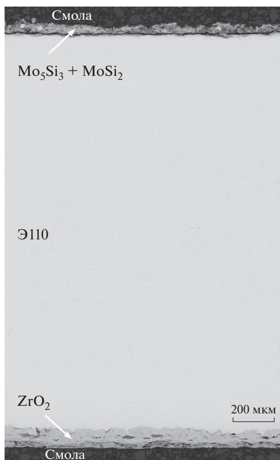
Рис. 7. Различные участки частично защищенного образца после испытаний на жаростойкость. Поперечное сечение, режим детектирования отраженных электронов.
