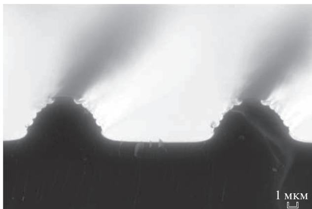
**Рис. 8.** РЭМ-изображение поперечного сечения структур, количество циклов травления – 6, селективность  $S(\text{Si}/\text{mask}) \sim 1.5$ .
