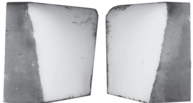
**Рис. 5.** Состояние рабочих поверхностей шашек при работе в “точке науглероживания”.
