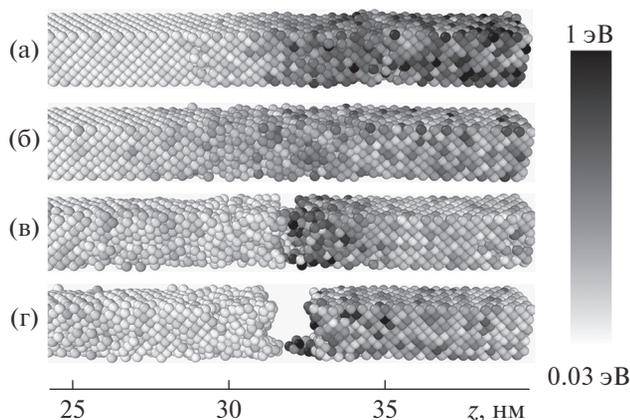
**Рис. 2.** Динамика структурных изменений в глубине мишени при облучении четырьмя ионами меди с энергией 2 кэВ в моменты времени: 8 (а); 9 (б); 10 (в); 11 пс (г). Размер мишени  $2 \times 2 \times 40$  нм.
