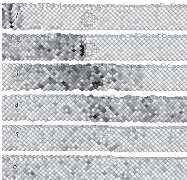
**Рис. 4.** Динамика ударной волны и ее влияние на пору с размером 1 нм на глубине мишени 25 нм при облучении четырьмя ионами меди с энергией 1 кэВ в разные моменты времени: 3 (1); 4 (2); 5 (3); 6 (4); 10 (5); 20 пс (6). Размер мишени  $1.8 \times 1.8 \times 72$  нм.
