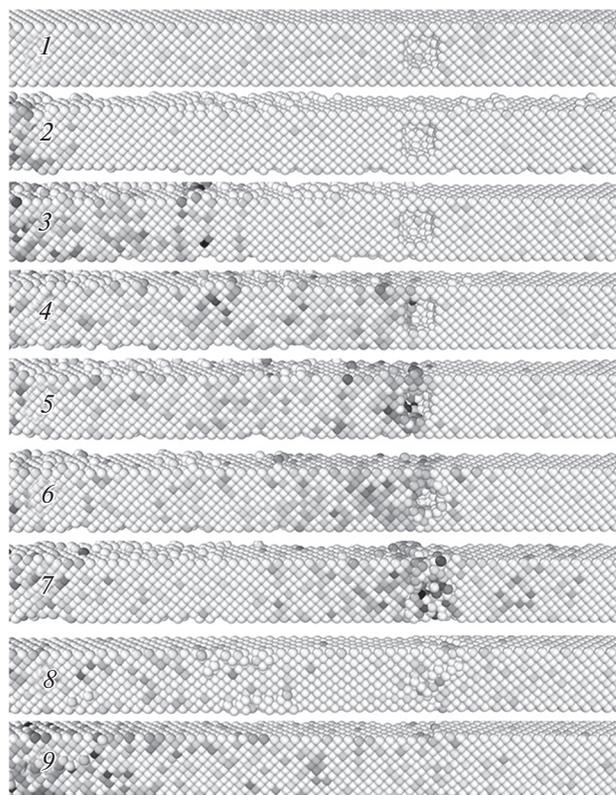
**Рис. 3.** Динамика ударной волны и ее влияние на пору размером 1 нм на глубине мишени 20 нм при облучении двумя ионами меди с энергией 1.5 кэВ в разные моменты времени: 0 (1); 1 (2); 2 (3); 3 (4); 3.2 (5); 3.4 (6); 4 (7); 8 (8); 12 пс (9). Размер мишени  $2 \times 2 \times 40$  нм.
