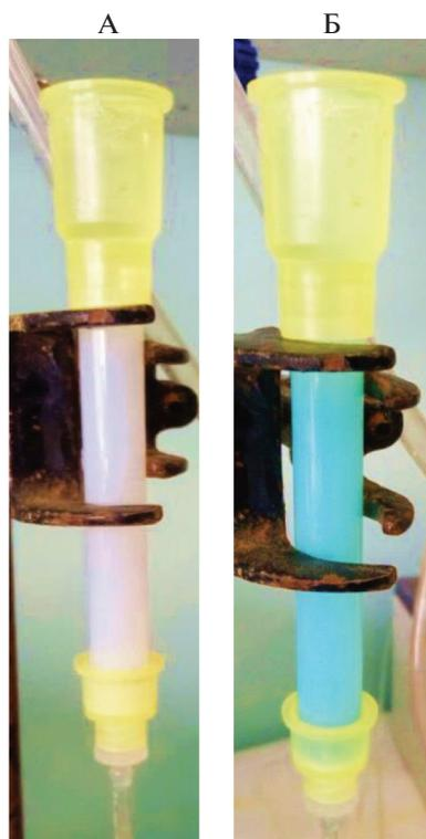
Рис. 2. Внешний вид колонки с IMAC-Sepharose 6FF до (А) и после (Б) “зарядки” катионами меди.
