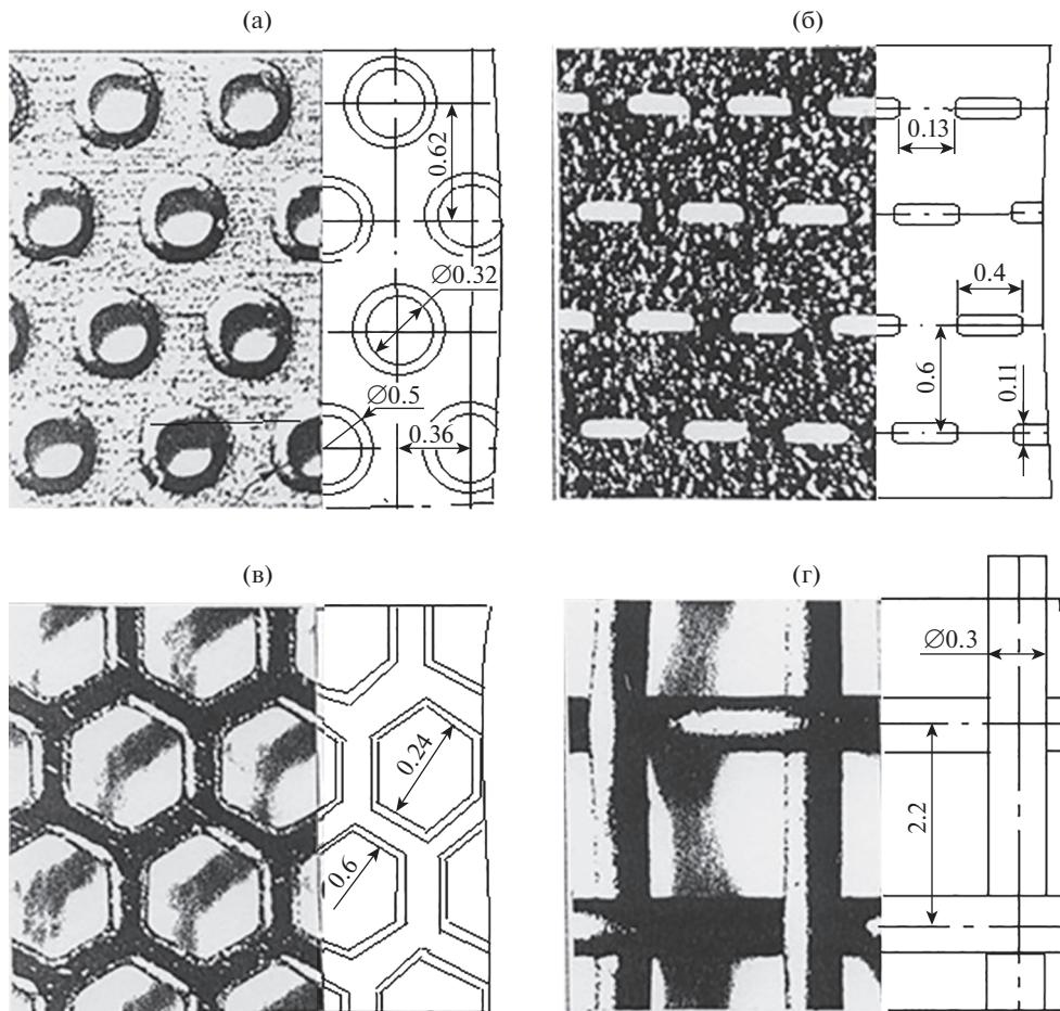
**Рис. 1.** Маски, используемые для создания РПМР: (а) – с круглыми отверстиями; (б) – с овальными отверстиями; (в) – с шестиугольными отверстиями; (г) – плетеная сетка из нержавеющей стали.
