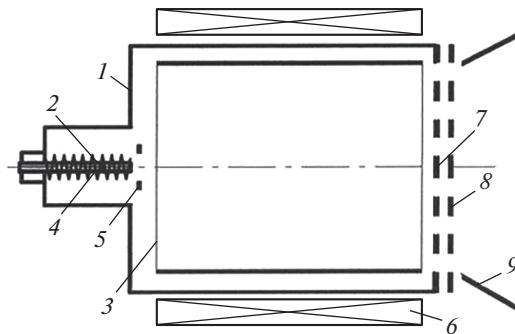
Рис. 2. Принципиальная схема ионного газового источника МАИ-208-2Т.
