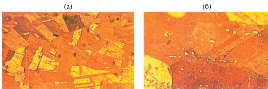
**Рис. 7.** Микроструктура исследуемого образца сплава BrX0,8 в продольном сечении: (а) – увеличение  $\times 100$ ; (б) – увеличение  $\times 500$ .
