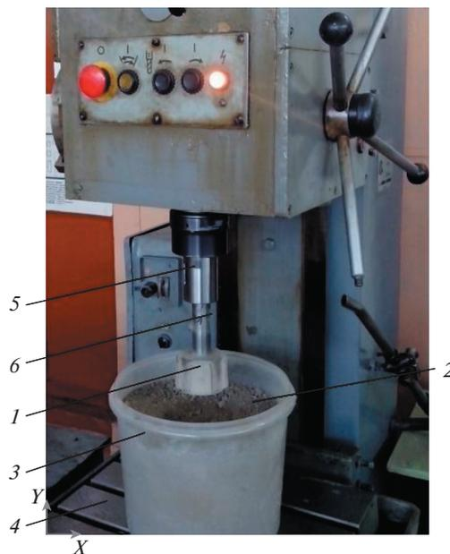
**Рис. 1.** Общий вид испытательного устройства: 1 – образец со сформированными покрытиями; 2 – абразивный материал; 3 – емкость; 4 – станина станка; 5 – шпиндель станка; 6 – оправка.
