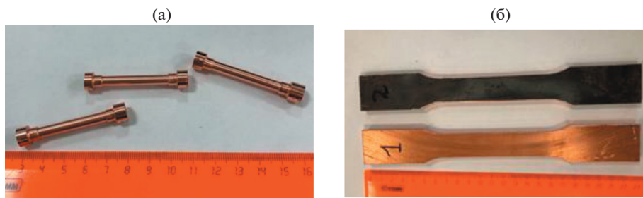
Рис. 3. Образцы для испытания на растяжение: (а) – цилиндрические; (б) – плоские.
