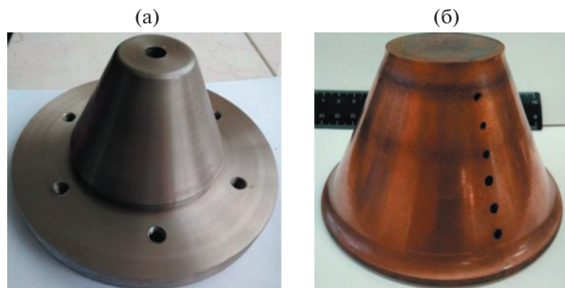
Рис. 8. Оправка (а) и заготовка (б) после первого перехода ротационной вытяжки.
