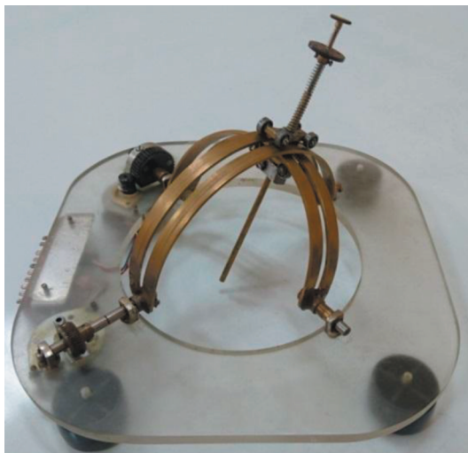
Рис. 3. Механизм с дугообразными звеньями, обеспечивающий постоянную точку ввода.
