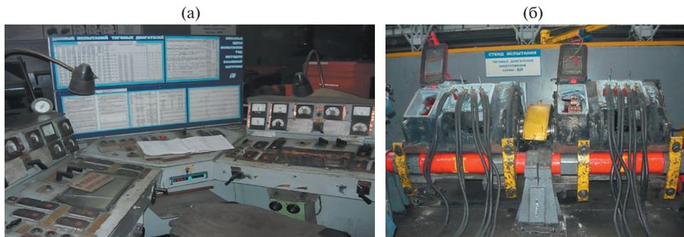
**Рис. 4.** Испытательная станция: (а) – внешний вид стенда для испытания тяговых двигателей в часовом режиме; (б) – стенд для испытания тяговых двигателей методом взаимной нагрузки.
