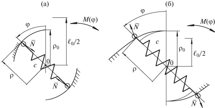
Рис. 1. Схема упругого шарнира: (а) – пружина сжимается; (б) – пружина растягивается.
