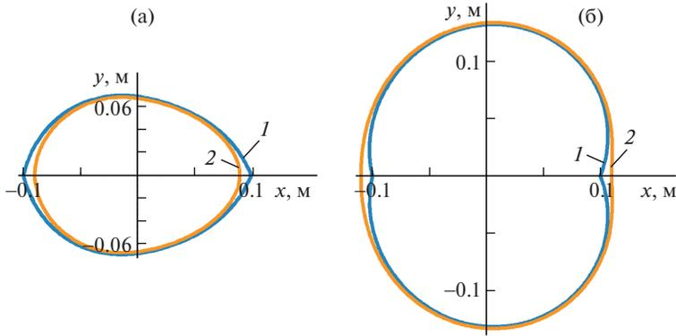
Рис. 2. Формы направляющих: (а) – пружина сжимается; (б) – пружина растягивается.
