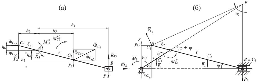
Рис. 5. Группа Ассур 2-го класса, 2-го порядка, 2-го вида – (а); кривошипно-шатунный механизм с противовесом на шатуне – (б).
