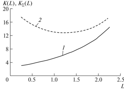
**Рис. 2.** Зависимости суммарной относительной удельной податливости зуба зубчатого колеса  $K(L)$ : линия – 1 и для однопарного зацепления  $K_{\Sigma}(L)$ : линия – 2, от положения точки приложения нагрузки  $L$ .
