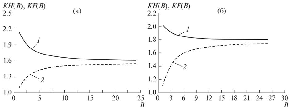
Рис. 5. Зависимость коэффициентов неравномерности распределения нагрузки (линия 1)  $K_H = KH$  и напряжений изгиба зуба (линия 2)  $K_F = KF$  от его относительной длины  $B = b/m$  при  $\beta^* = \beta b E / q = 20$ : (а) – приложение нагрузки к вершине зуба ( $l = 2.25m$ ); (б) – приложение нагрузки в полюсе зацепления ( $l = 1.25m$ ).
