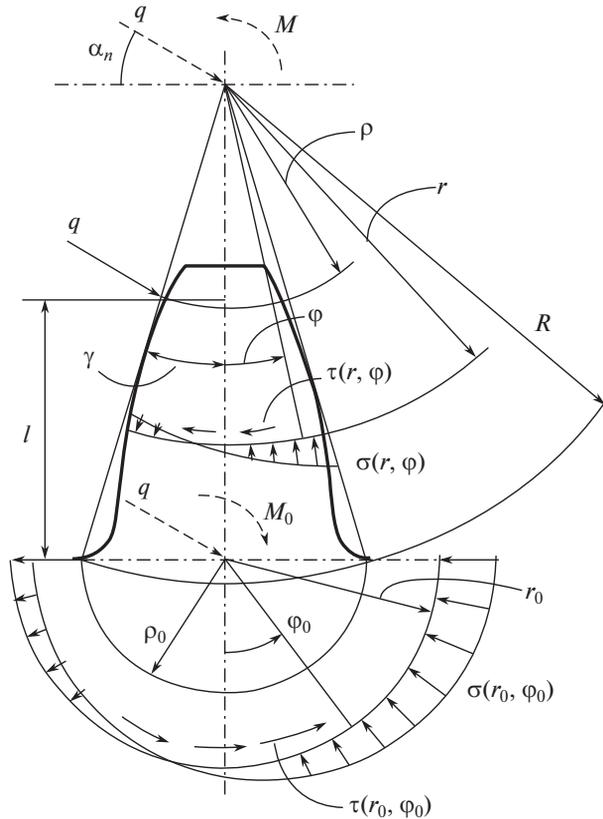
Рис. 1. Расчетная схема зуба колеса.
