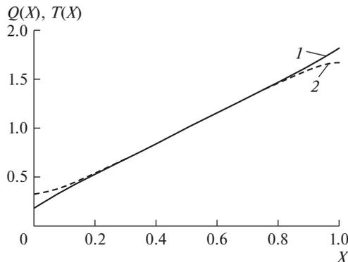
Рис. 4. Распределение относительной нагрузки (линия 1)  $Q(X)$  и относительного момента изгиба зуба (линия 2)  $T(X)$  по его длине при  $\beta^* = \beta b E / q = 20$ ,  $l = 1.25m$ ,  $b = 10m$ .
