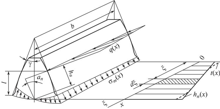
Рис. 3. К определению законов распределения нагрузки и напряжений изгиба по длине зуба колеса.
