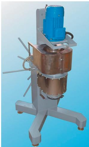
Рис. 1. Экспериментальная установка волнового смешивания VM-58.
