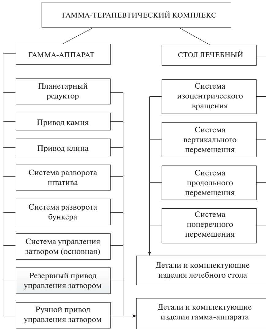
Рис. 3. Результат структурной декомпозиции механической части ГТК.
