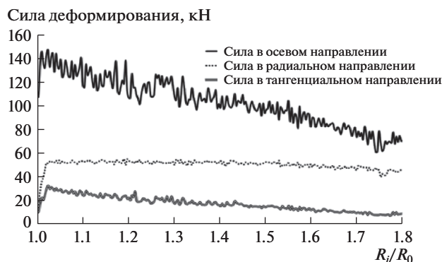
Рис. 4. Изменения сил деформирования на ролике в процессе раскатки диска.
