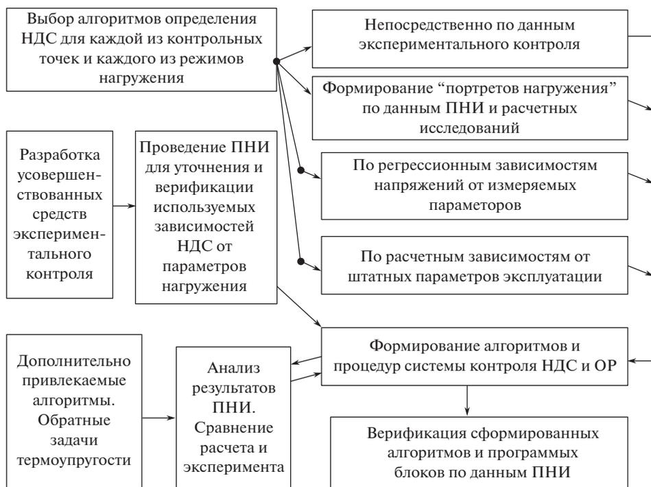
**Рис. 1.** Алгоритм реализации системы диагностического контроля НДС, основанной на расчетно-экспериментальных методах и процедурах.
