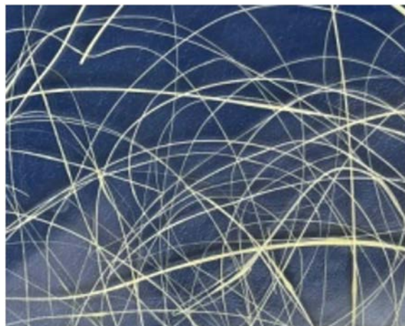
Рис. 3. Фото сформованных вручную полимерных волокон из органоалюмоксана, модифицированного гафнием (табл. 2, образец 3).
