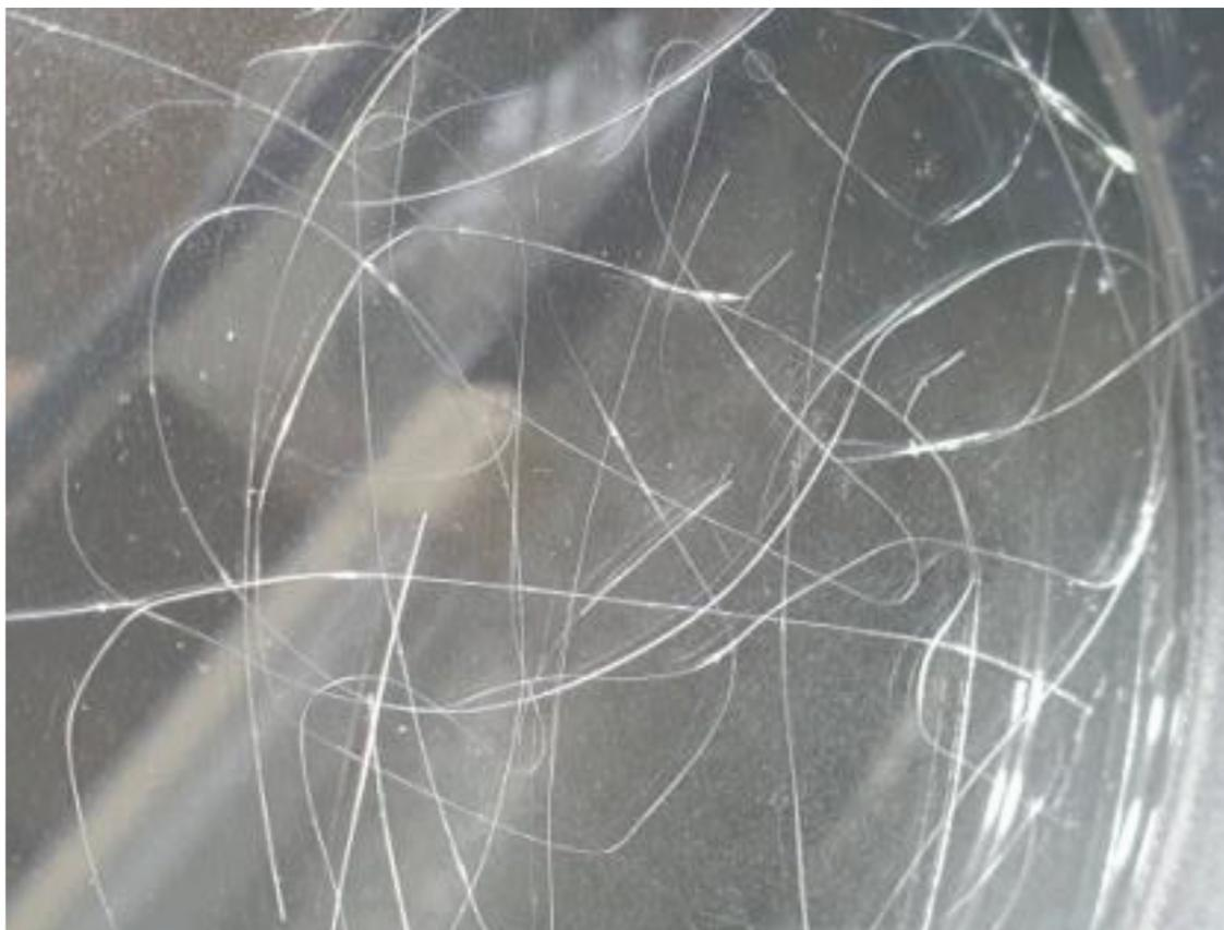
Рис. 5. Фото сформованных вручную полимерных волокон из гафнийоксантирийоксаналюмоксана (табл. 2, образец 4).
