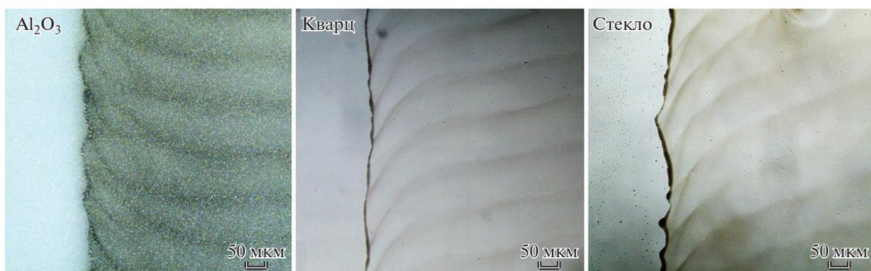
Рис. 5. Оптические микрофотографии тонких пленок  $MnO_x$ , напечатанных на подложках различного типа.
