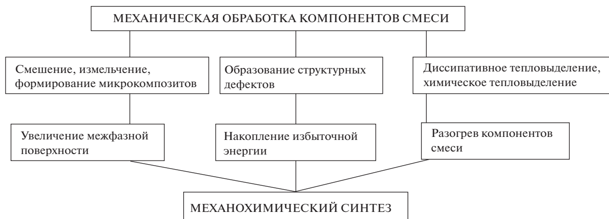
Рис. 5. Факторы ускорения химического превращения при механообработке.
