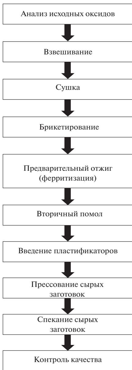
Рис. 1. Технологическая схема получения ферритов-шпинелей состава \text{Li}_{0.33}\text{Fe}_{2.29}\text{Zn}_{0.21}\text{Mn}_{0.17}\text{O}_4 методом керамической технологии.
