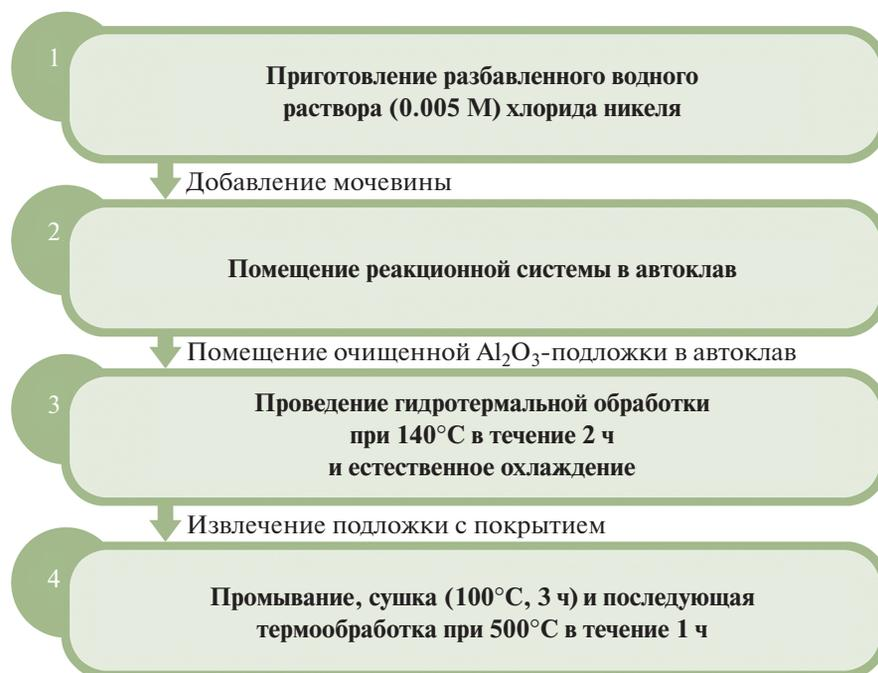
Рис. 1. Схема роста иерархически организованных покрытий NiO в гидротермальных условиях.
