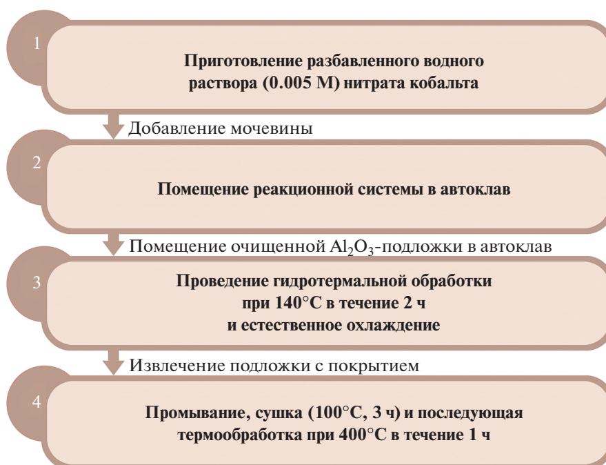
Рис. 1. Схема получения иерархически организованного покрытия \text{Co}_3\text{O}_4 на поверхности \text{Al}_2\text{O}_3 -подложки.
