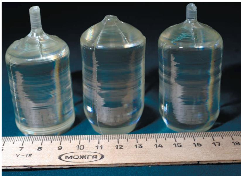
Рис. 4. Внешний вид кристаллов LiNbO<sub>3</sub>:Mg:Zn, выращенных методом Чохральского.
