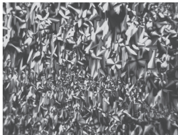
Рис. 3. Негеометрическая текстура соединения G3-K2.10 , в цикле нагрева T = 353 К, увеличение 100.
