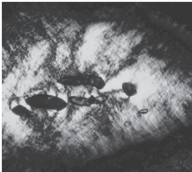
Рис. 4. Негеометрическая текстура соединения G3-K2.10 \cdot (FeCl_2)_{15} , в цикле нагрева T = 368 К, увеличение 100.
