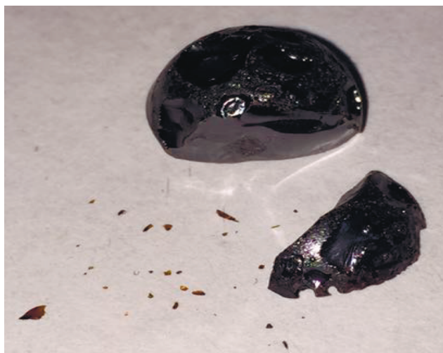
Рис. 1. Фотография стекла состава (\text{Ga}_2\text{S}_3)_{0.70}(\text{Nd}_2\text{S}_3)_{0.25}(\text{EuS})_{0.05} .
