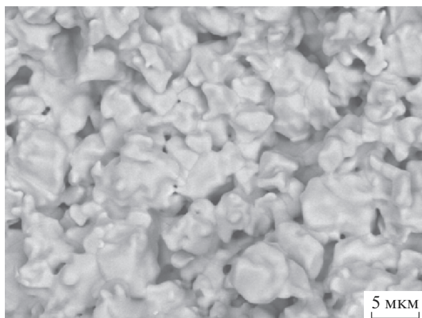
Рис. 3. Микроизображение скола спеченного брикета \text{Vi}_3\text{Nb}_{0.2}\text{Er}_{0.8}\text{O}_{7-\delta} . Изображение получено в отраженных электронах.
