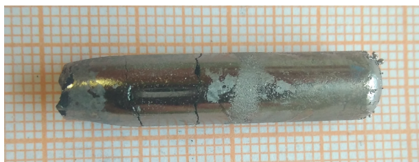
Рис. 1. Слиток сплава эвтектики системы ZnSnAs_2 – MnAs .
