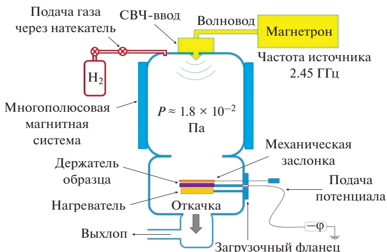
Рис. 2. Схематичное изображение установки ЭЦР плазмы. Вид сверху.
