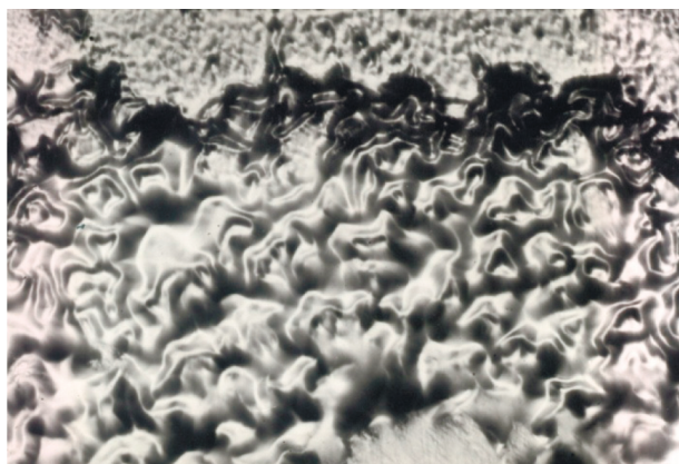
Рис. 3. Морфология поверхности пленки ванадия после вакуумного нагрева до 660°C.
