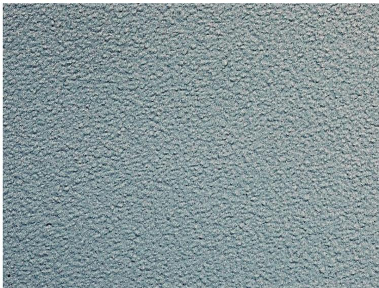
Рис. 6. Структура поверхности кремниевой подложки после химической обработки.
