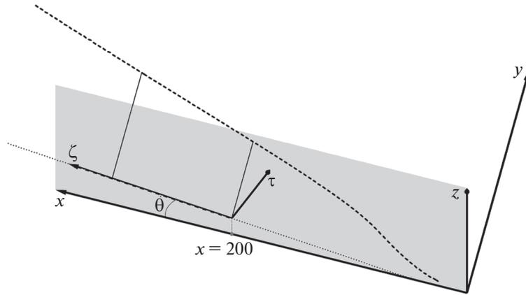
**Рис. 4.** Прямоугольные декартовы системы координат  $x, y, z$  и  $\zeta, y, \tau$ . Пунктир соответствует линии  $y = y_c(x)$ ,  $z = z_c(x)$ , точки – проекции пунктирной линии на плоскость  $y = 0$ . Ось  $\zeta$  направлена вдоль касательной к проекции пунктирной линии на плоскость  $y = 0$  в точке  $x = 200$ .
