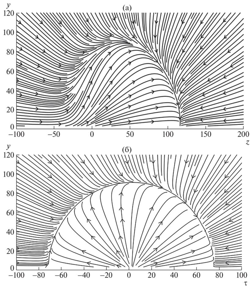
Рис. 3. (а) Линии тока поперечного течения при  $Re = 77$  и  $S = 0.56$  в сечении  $x = 600$  в исходной системе координат. (б) Линии тока поперечного течения при  $Re = 77$  и  $S = 0.56$  в сечении  $x = 600$  в новой системе координат.
