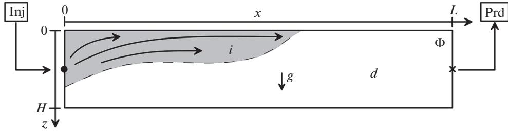
Рис. 1. Схема течения в области  $\Phi$  при  $\rho_i < \rho_d$ . Символы  $i$  и  $d$  показывают зоны, насыщенные вытесняющей и вытесняемой жидкостями соответственно. В области  $i$  происходит двухфазное течение обеих жидкостей.
