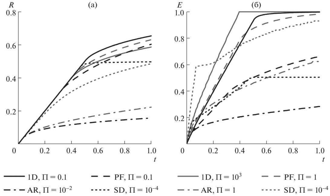
**Рис. 6.**  $R$  и  $E$  от  $t$  при  $M = 5$  в различных режимах вытеснения. Чёрные и серые кривые соответствуют большому и малому влиянию  $p_c$  соответственно.
