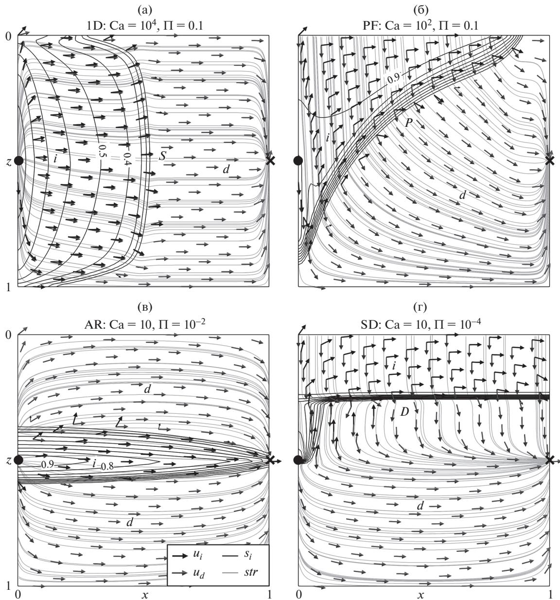
**Рис. 4.** Линии уровня  $s_i = \text{const}$ , мгновенные линии тока жидкости  $d$  (*str*) и направления скоростей  $u_i$  и  $u_d$  в режимах вытеснения 1D, PF, AR и SD при  $t = 0.25$  (а–г соответственно). Линии уровня  $s_i$  приводятся с шагом 0.1.
