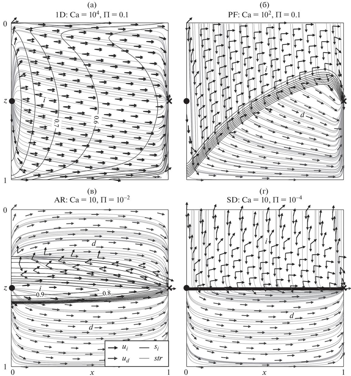
Рис. 5. Режимы вытеснения 1D, PF, AR и SD при  $t = 0.75$  (а–г соответственно). Все обозначения идентичны рис. 4.
