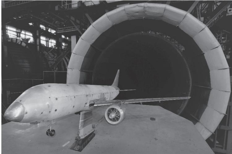
Рис. 1. Модель магистрального самолета в трубе Т-104.
