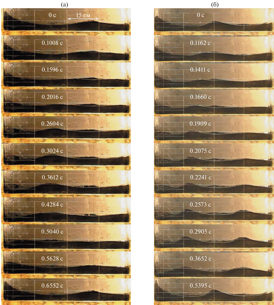
Рис. 3. Стоячие гравитационные волны на свободной поверхности воды в клиновидном сосуде: а–б – третья и четвертая волновые моды n = 3, 4 (по результатам видеосъемки 120 к/с). Здесь период волн T_{3,4} = 0.656 и 0.540 с; частота \omega_{3,4} = 2\pi/T_{3,4} = 9.578 и 11.635 с ^{-1} .
