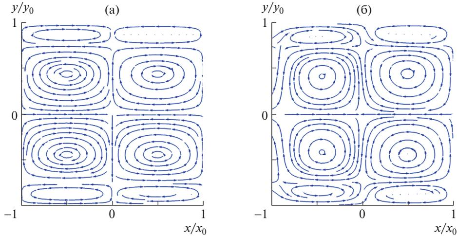
Рис. 4. Линии тока акустического течения: а – колеблющаяся каверна; б – колеблющаяся левая граница.
