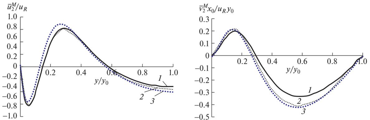
Рис. 3. Продольная (а) и поперечная (б) составляющие средней массовой скорости: 1 – результаты [10]; 2 – результаты [9]; 3 – настоящая работа.
