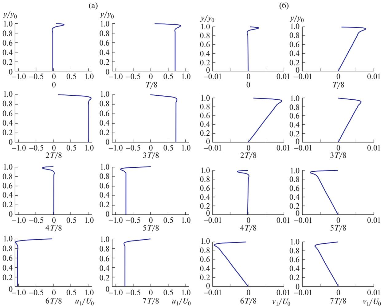
Рис. 2. Продольная (а) и поперечная (б) составляющие скорости первого приближения.
