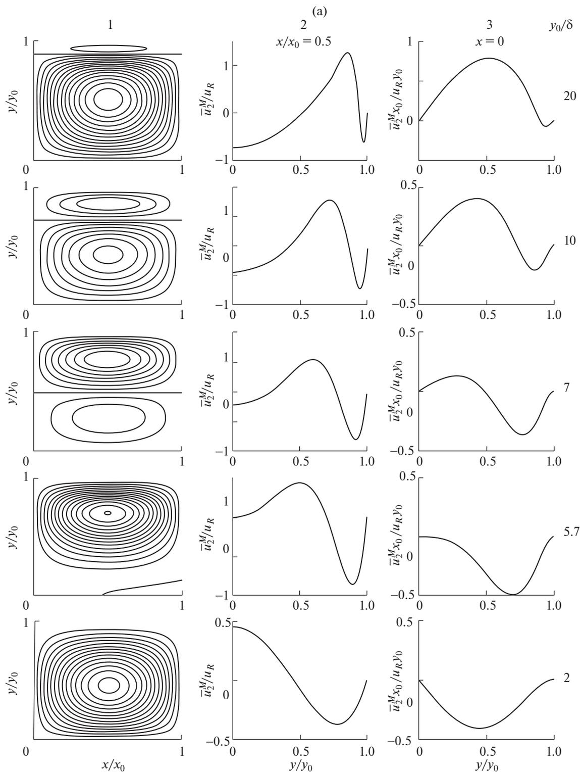
**Рис. 6.** Параметры акустического течения: а – [9]; б – результаты настоящей работы; 1 – линии тока; 2 – распределения продольной компоненты скорости в сечении  $x/x_0 = 0.5$  (сплошная линия – средняя массовая скорость, пунктирная линия – средняя скорость); 3 – распределения поперечной составляющей средней массовой скорости в сечении  $x/x_0 = 0$ .
