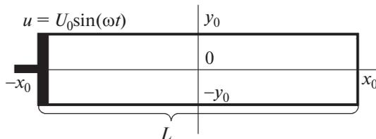
Рис. 1. Прямоугольный резонатор.
